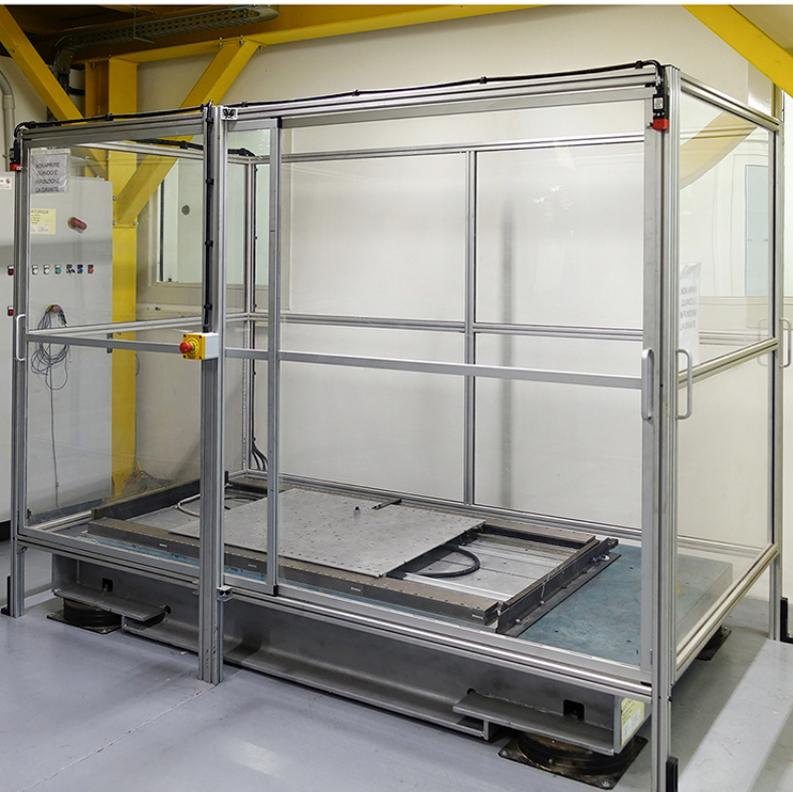
*Il Low Frequency High Stroke shaker è un sistema innovativo basato sulla tecnologia a motori lineari.*
