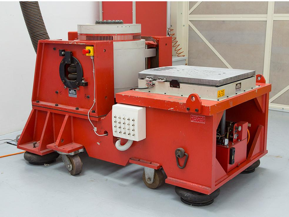
*Shaker elettrodinamico per prove di vibrazione dotato di slip table per l'esecuzione di test sui tre assi.*
