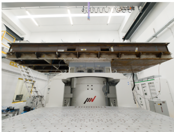
Unità HVAC da 4,3 m su shaker 200 kN con expander guidato
