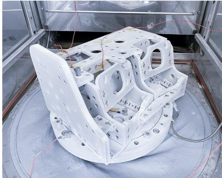
L'Instant Clamp adotta una componentistica che le permette di lavorare in un range di temperatura compreso tra  $-40\text{ }^{\circ}\text{C}$  e  $+160\text{ }^{\circ}\text{C}$ , quindi è adatta anche per test combinati in camera climatica, ambiente solitamente piuttosto problematico per il montaggio del setup di test.
