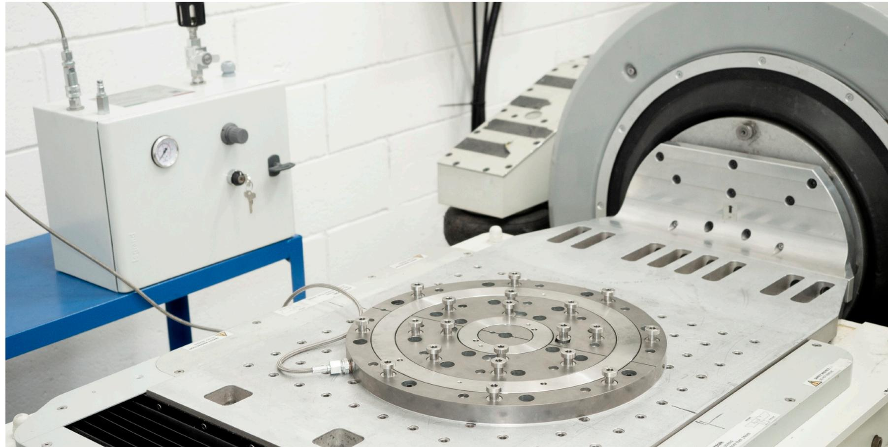
L'**Instant Clamp** può essere ordinata con le dimensioni standard per l'armatura degli shaker più diffusi o con dimensioni e forme specifiche.
