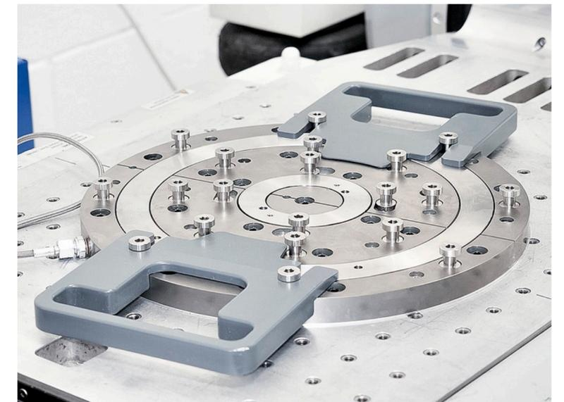
Il serraggio è equivalente a quello delle viti serrate a coppia, di conseguenza è stata testata con successo sia su shaker che su sliptable per test sine, random e shock fino a **2.000 Hz**.
