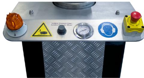
Sul **PANNELLO DI CONTROLLO** della macchina sono rimasti solo il regolatore di pressione e il manometro relativo all'isolamento della macchina dal suolo.
